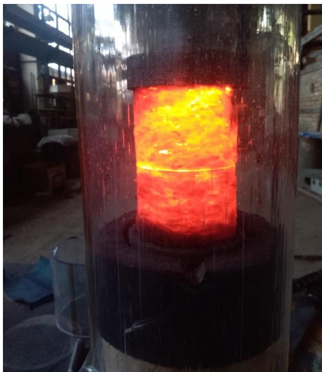
Рисунок 2.7. Тестові випробування резистивного нагрівача.
