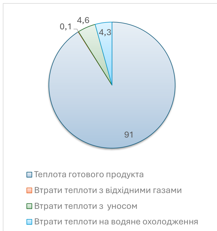
Рисунок 5.3. Структура теплового балансу печі ЕКШ, % [23]
